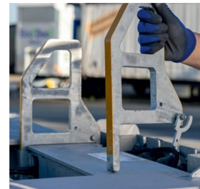
Leicht auswechselbare Containerführungen für Container am Frontbalken.
