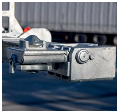
Klappverriegelung am starren Frontbalken in der Twist Lock -Position.
