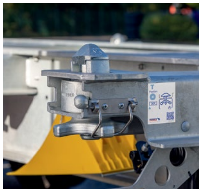
Twist Locks mit Sicherung gegen Verdrehen an vier Paar Containerbalken als Standardverriegelung.
