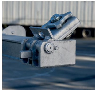
Klappverriegelung als PIN-Verriegelung für Tunnelcontainer am Frontbalken.
