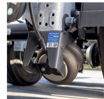
Die Liftachse* als Anfahrhilfe verlängert den Radstand und verstärkt damit den Druck auf die Antriebsachse. Unbeladen reduziert sich in gelifteter Position der Reifenverschleiß.
