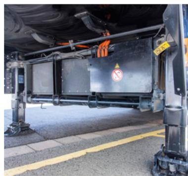
**Battery Power Pack** mit einer Kapazität von 32 kWh. Der Lithium-Eisenphosphat-Akkumulator hat eine autarke Laufzeit von ca. 4,5 h und benötigt ca. 2 h für eine vollständige Ladung.
