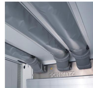
**Effiziente Luftführung** – zur gleichmäßigen Temperierung im gesamten Frachtraum – reduziert den Energieaufwand und sorgt für mehr Frachtsicherheit.
