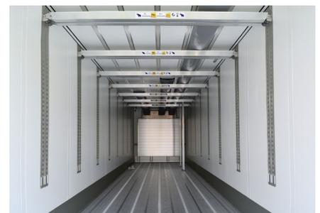
**Zuverlässige Ladungssicherung:** Der S.KOe COOL bietet zahlreiche Optionen angepasst an Ihre Transportbedürfnisse. Ein intelligentes System aus Ladungssicherungsschienen und Zurrösen sorgt für sicheres und einfaches Be- und Entladen.
