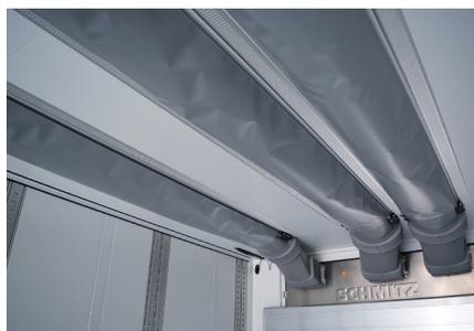
**Effiziente Luftführung:** Durch drei Luftkanäle mit anfahrresistenter Hutze wird die temperierte Luft mit geringem Energieaufwand gleichmäßig im Aufbau verteilt.
