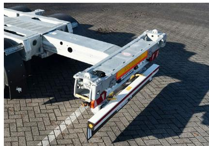
Neu: Der Heckausschub fährt pneumatisch die gewählte Verriegelungsposition an und bremsst sanft ab.
