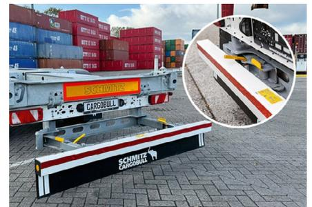
Neu konstruiert: Der ausziehbare Unterfahrerschutz für 45' Container bringt mehr Ergonomie und ist einfacher und sicherer im Handling ohne lose Teile, die verloren gehen können.
