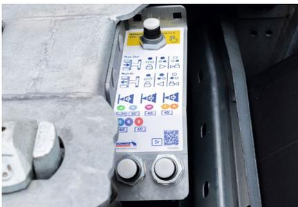
Steuerung für den pneumatischen Heckausschub mit manueller Verriegelung.
