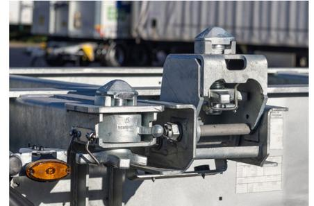
Bei 2 x 20' Beladungen übernimmt der höhenverstellbare **KLAPP LOCK** die Verriegelung des vorderen Containers.
