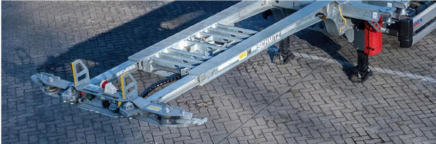
**MULTI LOCK** am Frontbalken mit Verriegelungspositionen für Tunnelcontainer mit schrägen Ecken, geraden Ecken und für Container ohne Tunnel, mit zwangsgeführter Stecksicherung.
