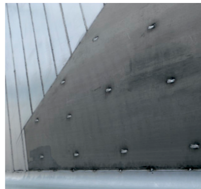
Las chapas de desgaste adicionales en la parte trasera prolongan la durabilidad de la caja.
