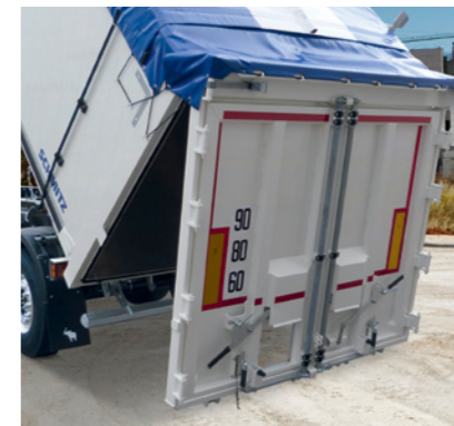
Posibilidad de descarga con la lona de techo cerrada usando la función basculante de la puerta combinada. Ahorra tiempo al descargar.
