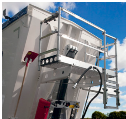
Plataforma de trabajo regulable en altura con suelo antideslizante para el manejo de la lona enrollable. De fácil acceso y con soporte para la manguera hidráulica.
