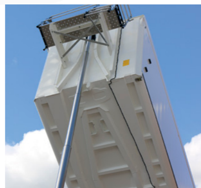
Zona del cuello parcialmente empotrada en la parte inferior de la carrocería para una altura más reducida.
