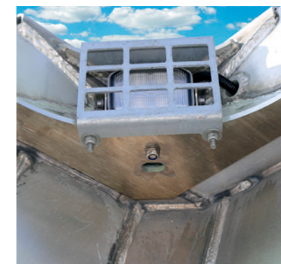
La iluminación interior de la caja de aluminio permite la limpieza o el manejo de mercancía paletizada, incluso con el techo cerrado.
