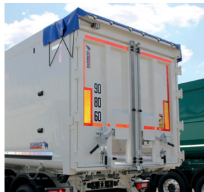
Puerta combinada con marco articulado, 2 hojas y 2 trampillas para cereales.
