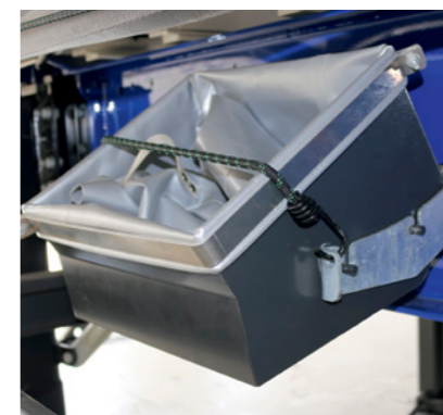
Tolva para descarga de cereales con una práctica posición de almacenamiento en chasis.
