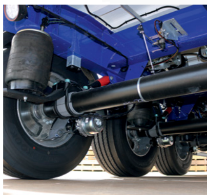
Tren de rodaje modelo ROTOS con freno de disco. Integra componentes de alta calidad de fabricantes de prestigio, con suspensión neumática multi-right-height (MRH). Idóneo para bajar el centro de gravedad durante la descarga.
