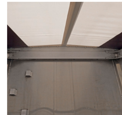
El diseño arqueado del techo enrollable, con un tubo central estabilizador, evita las acumulaciones de agua.
