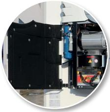
**El kit silencioso** instalado en la carcasa del equipo S.CU reduce el ruido del accionamiento a 94,9 dB (A).
