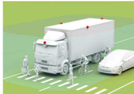
360 graders kamerasytem för maximal säkerhet.
