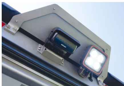
Backkamera* och LED-arbetsbelysning* ger extra säkerhet och förhindrar skador vid backning, dockning på ramp och manövrering.
