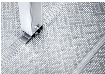
Multifunktionellt golv* med optimerathalkskydd, enkel lastsäkring vid montering av vertikala teleskopbalkar och hygienisk rengöring.
