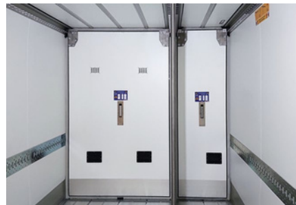
Skjutbar skiljevägg* tillverkad av ångdiffusions-FERROPLAST®: Snabb, variabelMultiTemp Skiljeväggar; finns som tillval för 1/3 och 2/3 uppdelning eller som en kontinuerlig vägg.
