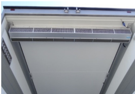
Luftgardin för att förhindra temperaturförlust medan lastning.
