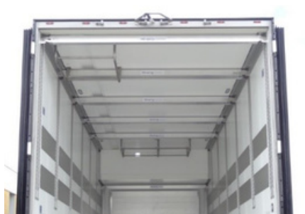
Dubbeldäckssystem som säkerställer dubbeltså många pallar.
