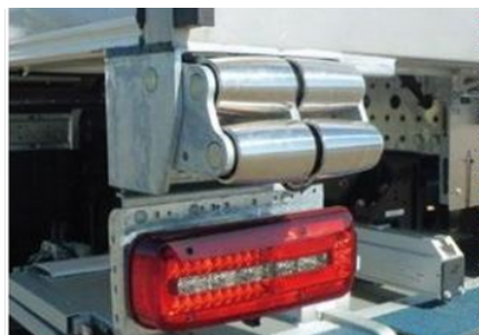
Dynamiskt ramtskydd, komprimerbart rullstötdämpare (DRP) och en dubbel gummilistskyddar bakpartiet när man närmar sig rampen.
