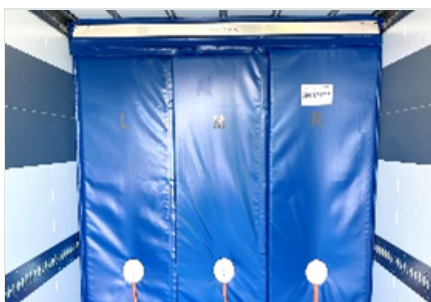
3-delad gardin, i längd- och tvärläng justerbar med magnethållare på ovsidan.
