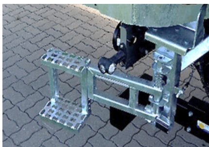
Ny hopfällbar steg med konstruktion som är kombinerad med SafeStart. Den är säkrare och mer bekväm att använda.
